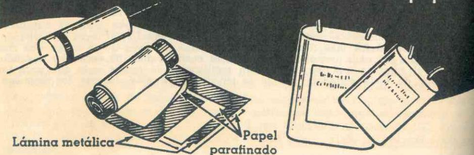
Los condensadores de papel no tienen polaridad y cuando se los hace trabajar dentro de los voltajes para los que han sido calculados duran mucho más que los condensadores electrolíticos. Sin embargo, los condensadores de papel de mucha capacidad son voluminosos y relativamente caros. No se fabrican normalmente para más de 16 mfd.
