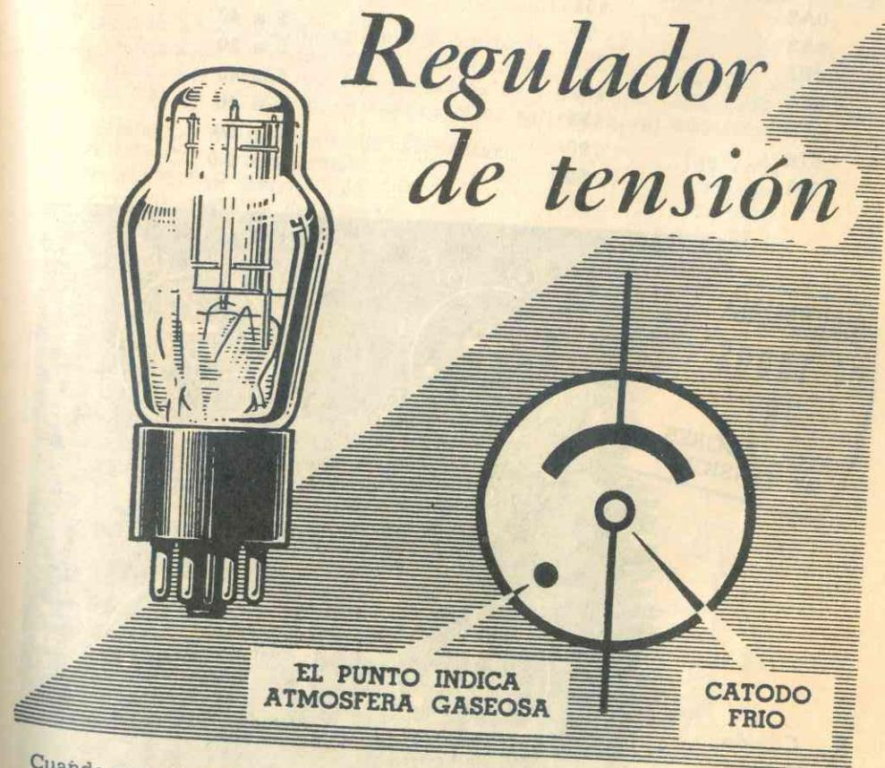
Cuando se aplica un potencial lo suficientemente grande entre el cátodo y la placa, el gas del interior del tubo se hace conductor y se establece una circulación de electrones del cátodo a la placa. La conductividad se caracteriza por una luminosidad azulada dentro del tubo — cuanto mayor la conductividad tanto mayor la luminosidad.
