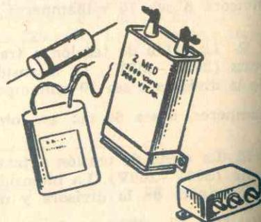
**CONDENSADORES DE FILTRO ELECTROLITICOS** — Comparados con los condensadores de papel, los electrolíticos tienen mucha mayor capacidad a igualdad de volumen. Tienen polaridad y se construyen generalmente para trabajar a menos de 600 volts. Hay una corriente de pérdida apreciable en los condensadores electrolíticos, pero este efecto queda generalmente compensado por sus grandes valores de capacidad. Los electrolíticos se fabrican para valores de 1 a 100 mfd.
