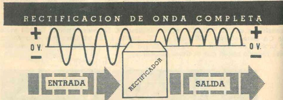
Observe que la salida de CC no está formada por un voltaje constante, sino que se eleva y cae al ritmo del voltaje de CA de entrada. Cuando solamente se permite pasar a través del rectificador a los semiciclos positivos del voltaje de entrada, y los semiciclos negativos no pueden pasar en absoluto, el proceso recibe el nombre de "rectificación de media onda".
