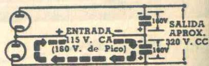
**FUENTE DE ALIMENTACION CON RECTIFICADOR METALICO SECO** — Los rectificadores metálicos secos pueden usarse en lugar de rectificadores de tubo de vacío. Los rectificadores metálicos secos son robustos, de larga vida, pequeño tamaño y capaces de intensas corrientes de salida. Pueden conectarse como circuitos rectificadores de media onda, de onda completa y dobladores de tensión.
