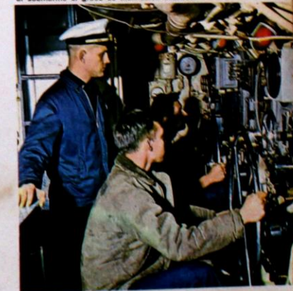
Dos marinos manobran el timón de profundidad para dar al submarino el grado de inclinación deseado.
